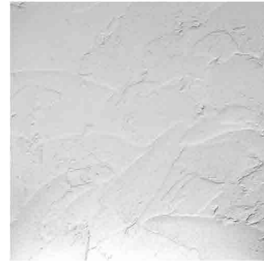
クラウド 不規則に勢いよく跳ね上げるコテの動きが、ワイルドな表情を醸す仕上げ。 仕上厚：3mm
