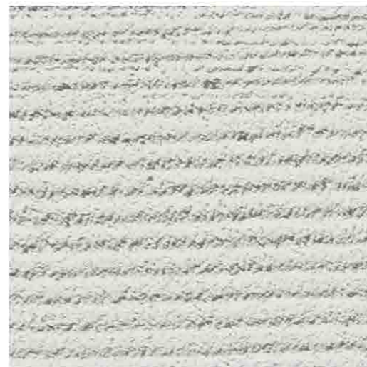
櫛引押さえ 櫛を引いた時にできる骨材の動きがラインに揺らぎを作るラフな仕上げ。 仕上厚：3mm
