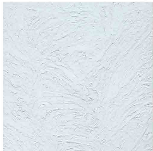
うず 木ゴテを回しながら模様をつけ、金ゴテで押さえた仕上げ。 仕上厚：3mm
