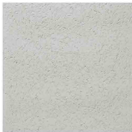
石調 掻き落とし仕上げの表面を金ゴテで押さえた仕上げ。 塗込厚：10mm 仕上厚：8mm
