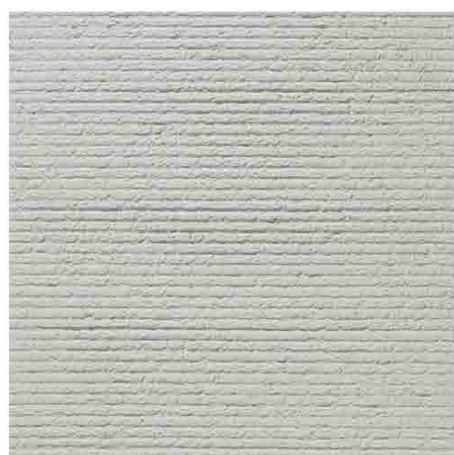
くし引きタロッシュ 材料塗り付け後、タロッシュで横引きに掻き落とした仕上げ。 塗込厚：10mm 仕上厚：8mm
