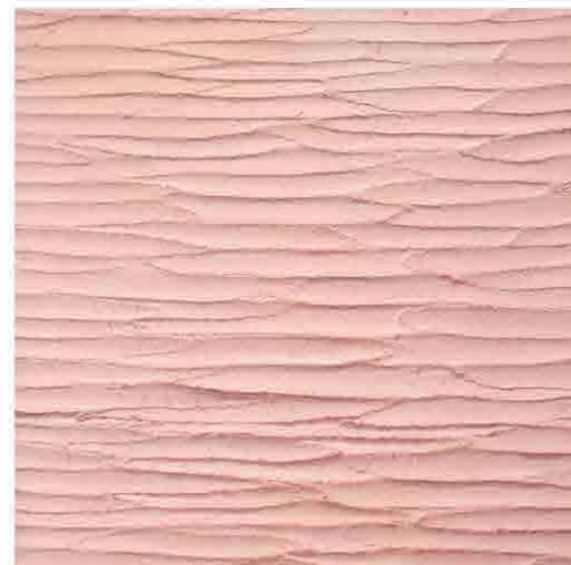
ポタニー (小面積限定) 細いコテで横引き模様を描いていく凹凸感のある仕上げ。 仕上厚：3mm
