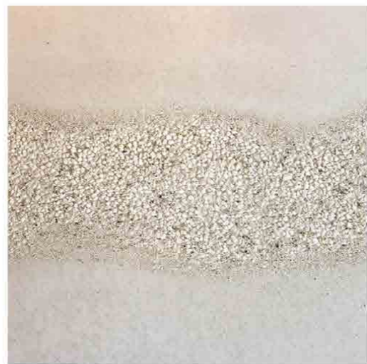
洗い出しライン 壁面をライン状に洗い出します。 ※全体に大きめの骨材を混ぜ合わせて作ります。 仕上厚：10~15mm
