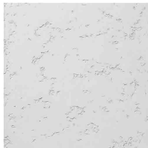
トラバーチン 材料を吹き付け、金ゴテで表面を押さえた仕上げ。 仕上厚：5mm
